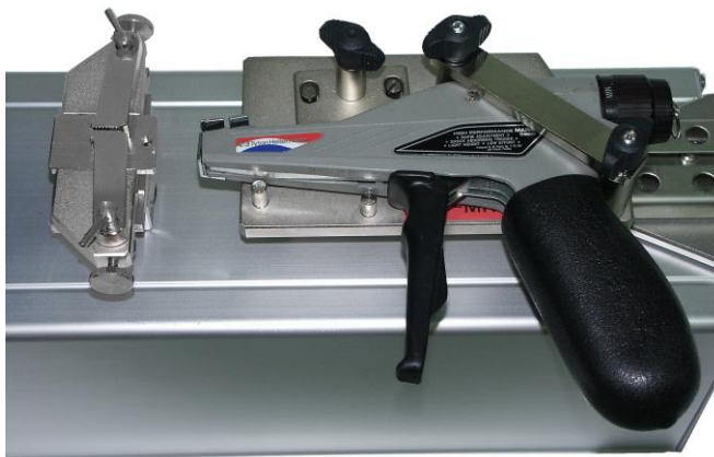
HellermannTyton MK 7 mit CGT 50 und Schnellspannhalter KSH 6
