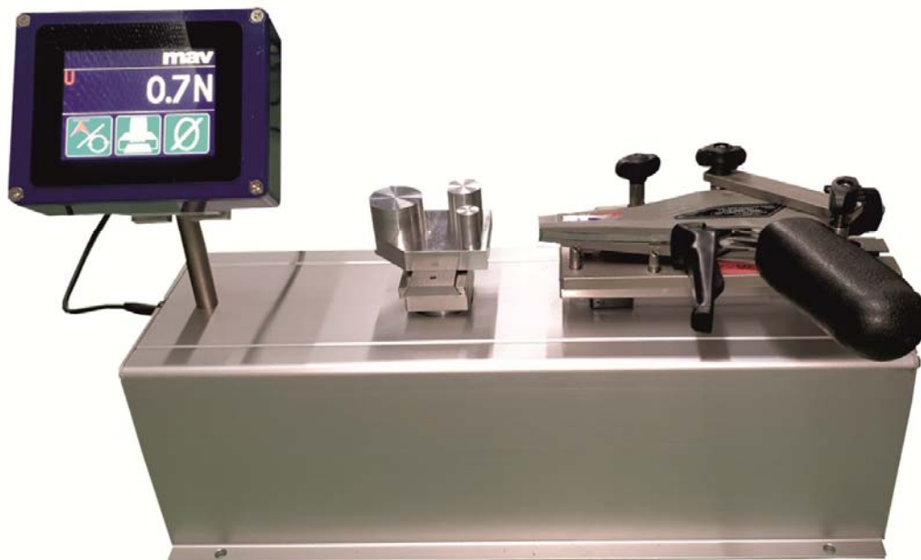
Clip Gun Tester GT-Touch 50 mit Werkzeugsatz KBP und HellermannTyton Kabelbinderpistole MK 7
