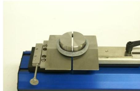
*Werkzeug für die Prüfung von Spritzen*
