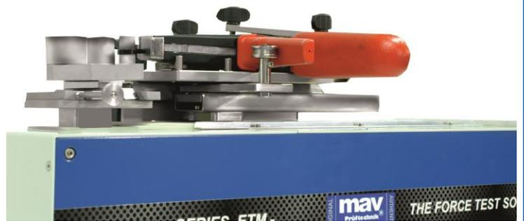
Das KBP-A Werkzeug ermöglicht eine kontinuierliche und gleichmäßige Prüfung durch den elektromotorischen Antrieb des Lastschlittens. Die Optionen Kraftvorwahl, Wegvorwahl und Geschwindigkeitsvorwahl können eingestellt werden.
