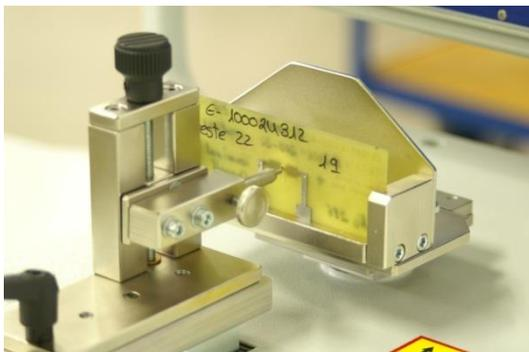
*Werkzeug für die Prüfung von Tabletten*
